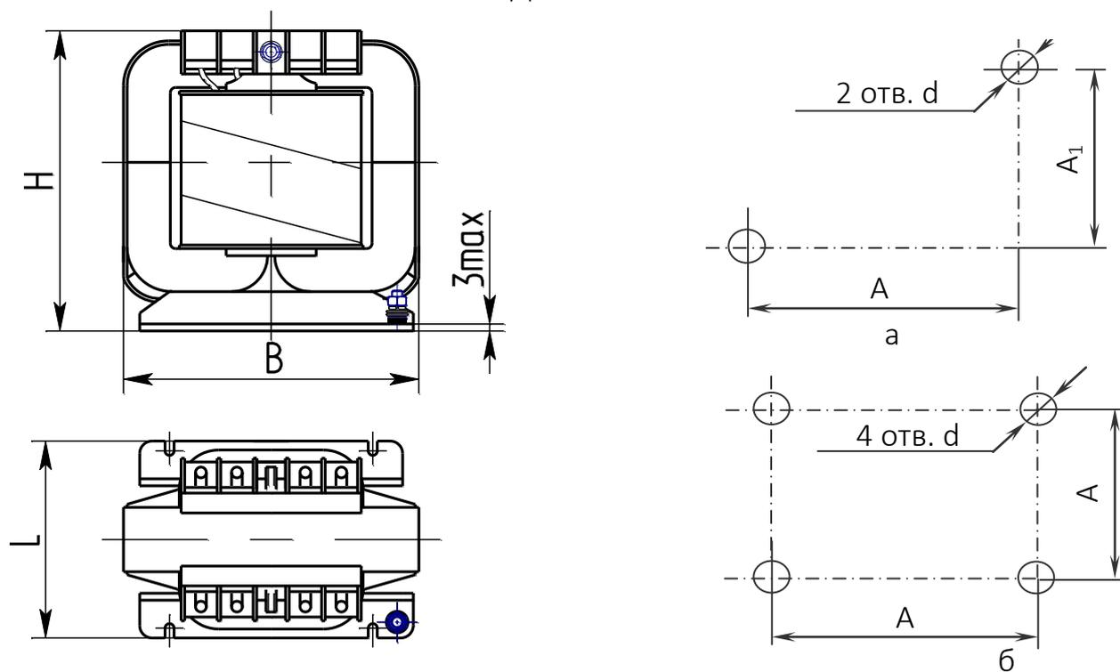
а – для трансформаторов мощностью 0,05 и 0,08
