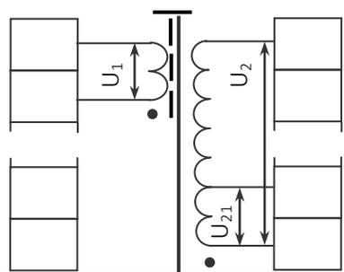
Примечание - Экран выполняется только в трансформаторах, содержащих обмотку 18 В.
